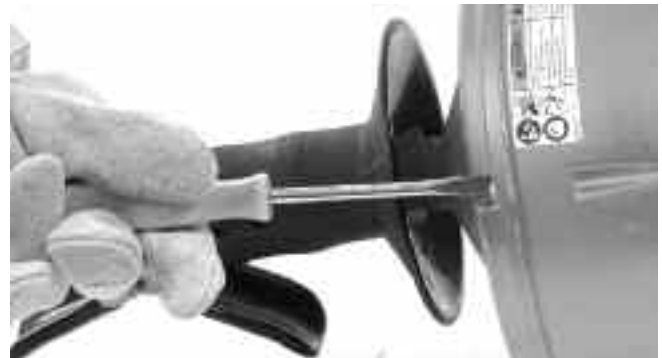
Рис. 13 – Слегка отверните 4 винта барабана примерно на 3 полных оборота, но не извлекайте их
